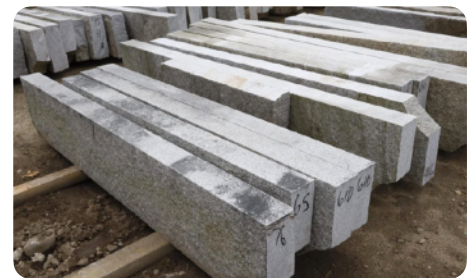
Boordstenen in natuursteen (van na het begin van de 20e eeuw) - vervaardiging met behulp van mechanisch gereedschap. De stenen hebben een gelijkmatige, nauwkeurige vorm. © stonecurators.com
