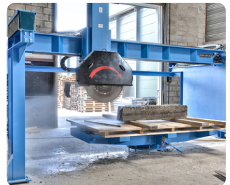
Overlangs verzagen van boordstenen © Steengroeve Bonneuil-sur-Marne
