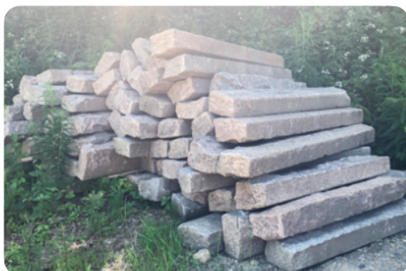
Hergebruikboordstenen in roze Zweedse graniet
