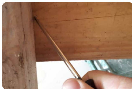
Test met een schroevendraaier © qualite.bzh
