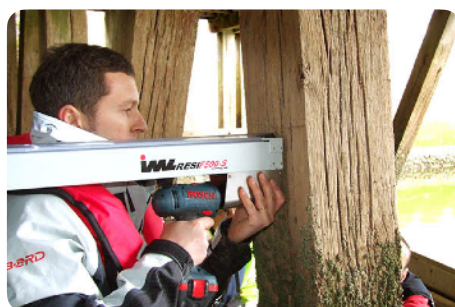
Hardheidstest met een resistograaf © qsb.fr
