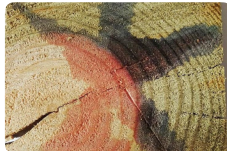
De blauwe verkleuring duidt op de aanwezigheid van een behandeling (hier beperkt tot het spinthout). © expert-bois.fr
